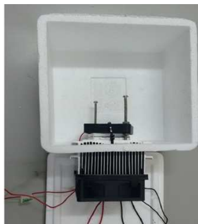
Figura 2.4 - Imagem fotográfica do Protótipo do refrigerador (a) tampado e com a fonte de tensão ao lado e (b) em destaque aberto (ESTÁGIO 4).
